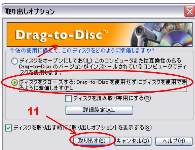
**11** 「Drag to Disc」の取り出しオプションが自動で起動します。「ディスクをクローズする」のラジオボタンを選択し、「取り出す」ボタンをクリックする。
